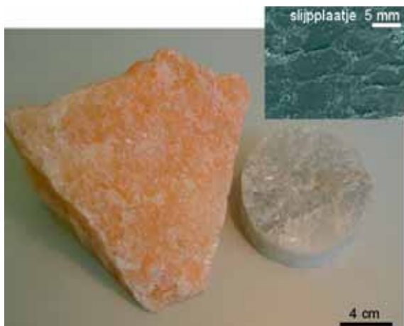
Afbeelding 1. Steenzout uit de Zechstein Groep met een samenstelling van meer dan 95% haliet. Let op de (poly)kristallijne structuur die zowel in de massieve monsters als in het slijpplaatje zichtbaar is. De perfect-kubische splijting van haliet zorgt voor de prachtige glinstering die zichtbaar is bij gebroken monsters.
