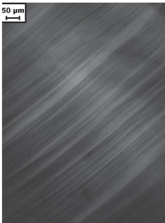
Afbeelding 6. Links: NaCl-kristallen voor en na plastische vervorming door verticale verkorting van 15% in een pers bij kamertemperatuur. De lijnen op het oppervlak van het vervormde kristal (rechts) zijn de sporen van een schuifbeweging langs prominente vlakken in het kristalrooster. Deze schuifbeweging vindt plaats doordat dislocaties door het kristal heen glijden (Afb. 7).
